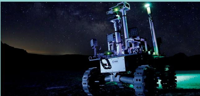
Los todoterrenos lunares deben diseñarse para que puedan circular por terrenos rocosos desconocidos, cubiertos de regolito y con pendientes inesperadas. El vehículo debe contar con ruedas especialmente pensadas para funcionar en esas condiciones sin ningún problema. Estos todoterrenos también deberán portar instrumental científico, como cámaras y taladros para tomar muestras. Asimismo deben tener autonomía y energía suficientes para recorrer grandes distancias.
